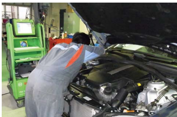
高度化が進んだ自動車整備にスキャンツールは必需品
